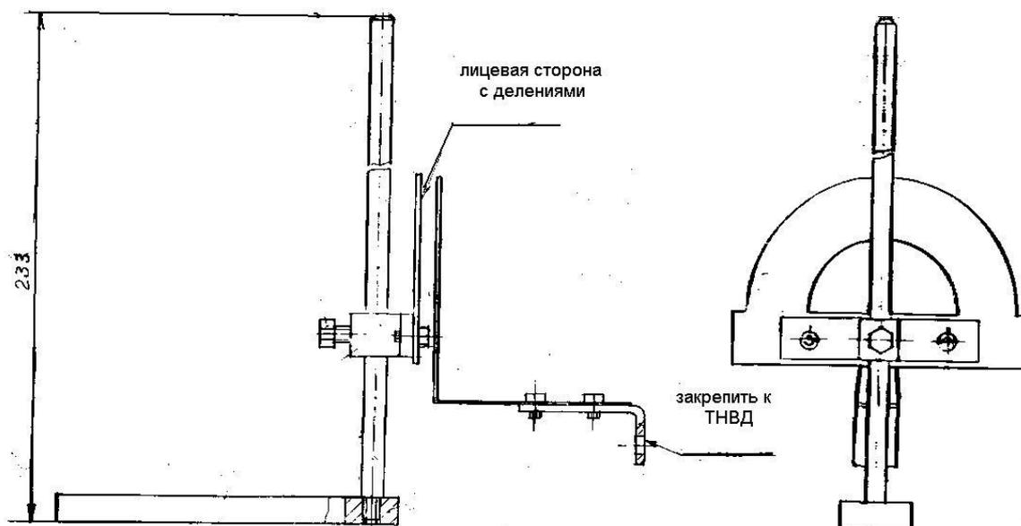
Рисунок 2. Приспособление для измерения угла поворота рычага ТНВД БОШ Р КОЭЗ-02.002.000
