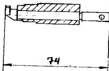
Рисунок 4 Фиксатор толкателя эксцентриковый (БОШ Р) КОЭЗ-02.004.000
