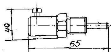
Рисунок 3. Приспособление для замера активного хода плунжера первой секции ТНВД БОШ Р КОЭЗ-02.003.000
