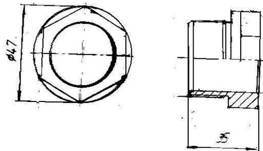
Рисунок 12. Втулка технологическая ТНВД БОШ PVA, Моторпал PVA, WSK
