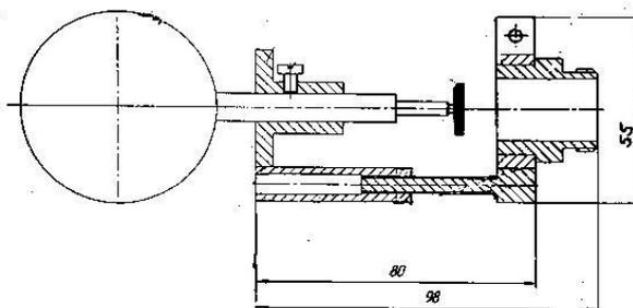
Рисунок 1. Приспособление для измерения хода рейки ТНВД БОШ Р КОЭЗ-02.001.000
