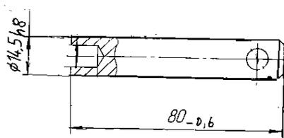
Рисунок 16 Ключ для разборки грузов
