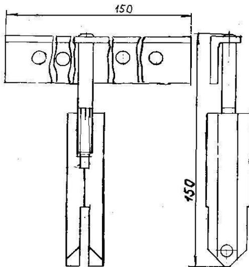
Рисунок 6. Приспособление для устанавливания толкателей (БОШ Р)
