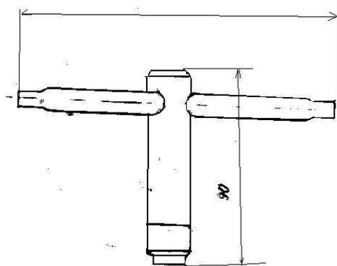
Рисунок 10. Съемник крестовины грузов регулятора ТНВД БОШ "Р"
