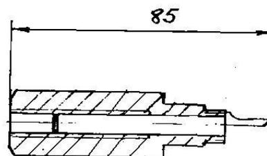
Рисунок 5. Фиксатор толкателя лопаточный (БОШ Р) КОЭЗ-02.005.000
