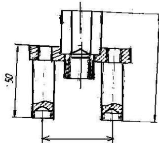
Рисунок 8. Съемник секций ТНВД
