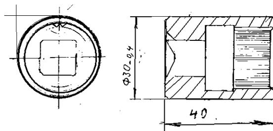
Рисунок 17 Головка для штуцеров
