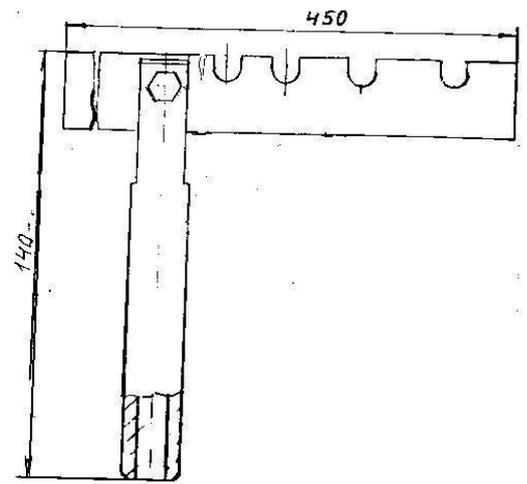
Рисунок 7. Приспособление для отжатия толкателей (БОШ Р)
