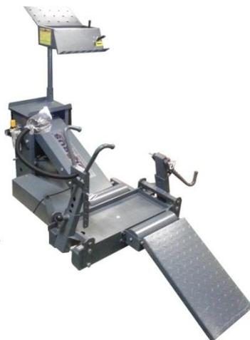
**Напольный борторасширитель для работы с грузовыми колесами с пневмолифтом и подсветкой рабочей зоны.**
